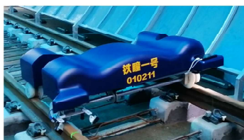
双轨轨检机器人——铁瞳一号
