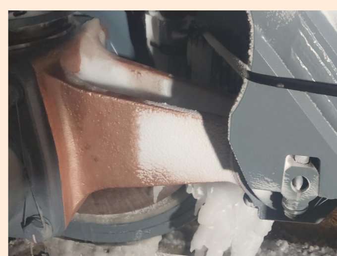
功能复合涂层融化转向架表面覆冰
