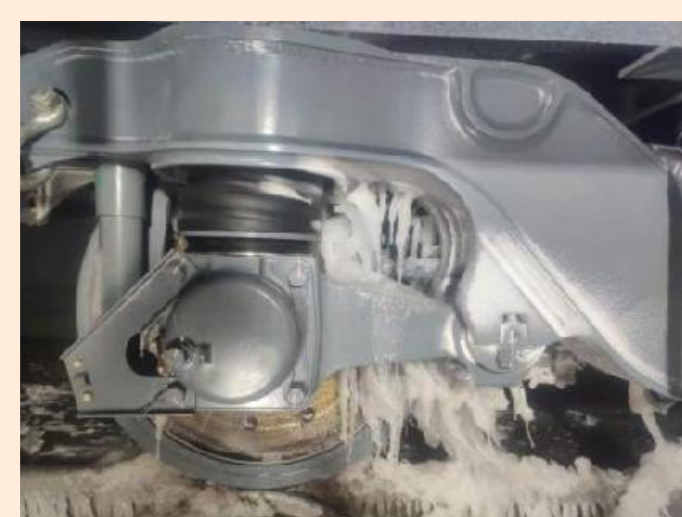
车体引流结构防止转向架积雪结冰
