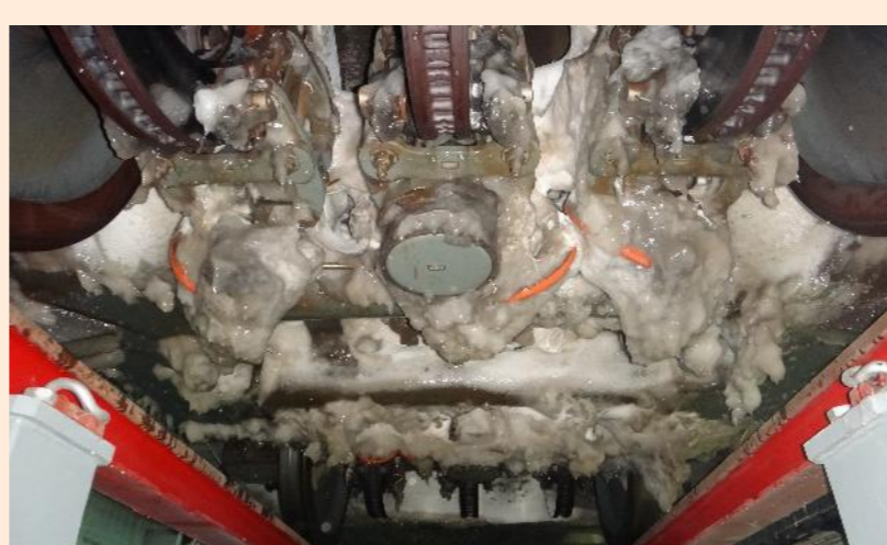
高寒列车转向架积雪结冰
