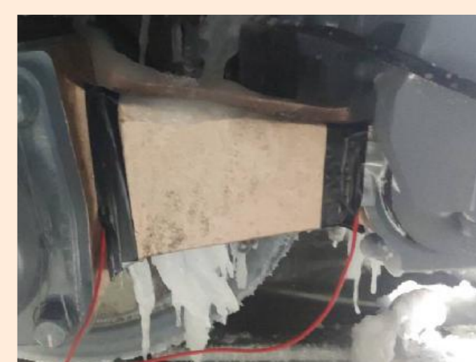
功能复合涂层融化转向架表面覆冰
