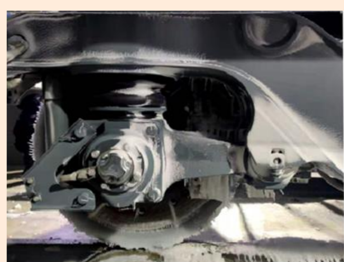
车体引流结构防止转向架积雪结冰
